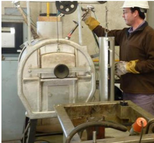
Se continúa con la extracción de la probeta a una temperatura de 850°C
