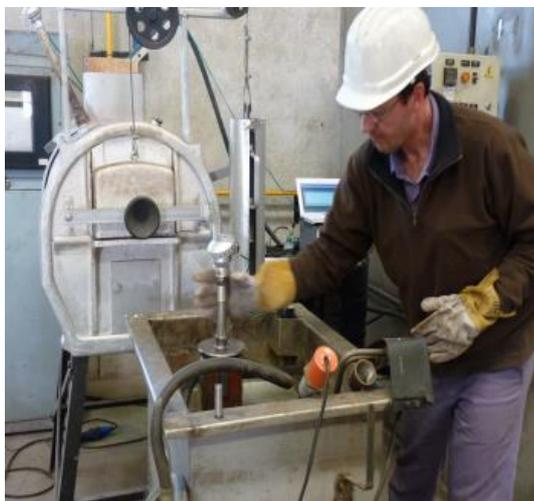
La probeta se coloca luego en la base de enfriamiento controlado y se deja en ella mientras el sistema traza la curva.
