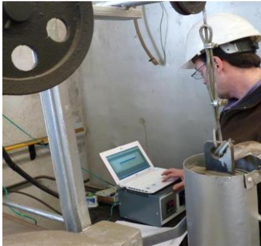
El ensayo se inicia con la carga de los datos en el programa FieldChart, que trazará luego cada curva. FieldChart es un software para Windows que permite la comunicación y tratamiento de los datos relevados en el equipo Provisto por Volpor.
